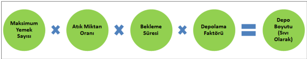
Şekil 4-2 Yağ Tutucu Boyutlandırılmasında Kullanılan Hesaplama Metodu
