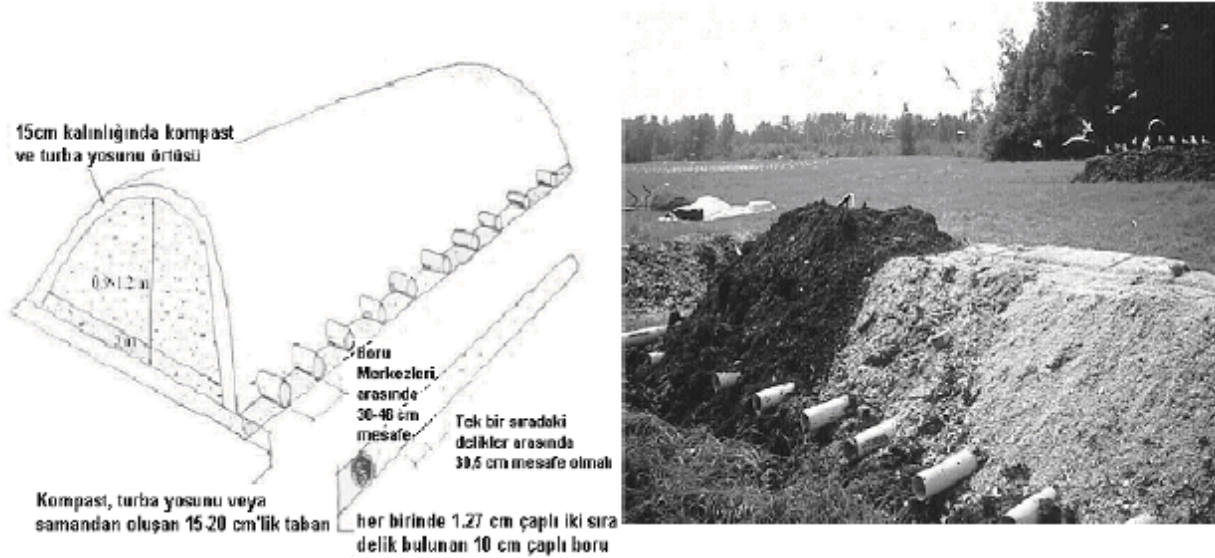
Şekil 3.6 Gübre Kompostlamasında Pasif Havalandırmalı Yığınlar
